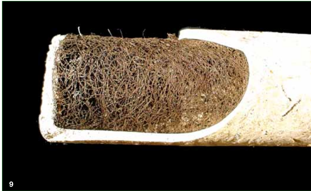
9. Beschädigter, großer Gießtopf. Gut zu erkennen ist das netzartige Wurzelsystem. Die Wurzeln haben sich den Weg durch eine der Aufhängebohrungen gesucht.
